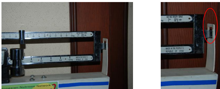
Gambar 7. Detecto menunjukan angka 0
